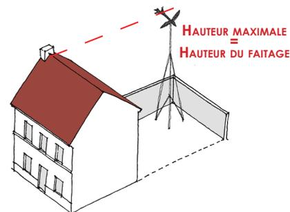
ÉOLIENNE À AXE HORIZONTAL PRINCIPLE D'IMPLANTATION ENVISAGEABLE : EN FOND DE PARCELLE ET LIMITÉE EN HAUTEUR
