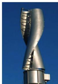
ÉOLIENNE À AXE VERTICAL (TYPE SAVONIUS)
