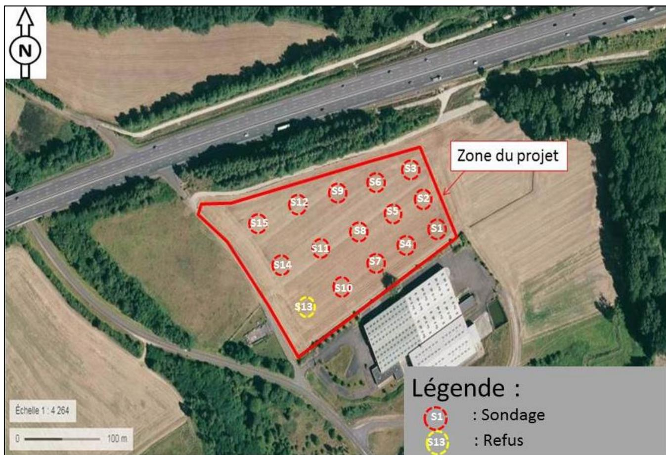
**Figure 10 : Localisation des sondages réalisés (Source : BURGEAP, 16 novembre 2017 ; Fond de plan : GEOPORTAIL)**
