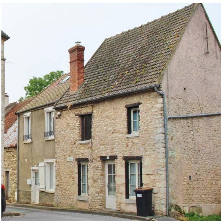
⚡ Moellons de calcaire réguliers pour les murs et de grande dimension en chaînes d'angle, bois pour les linteaux. Aunay-sous-Auneau.
